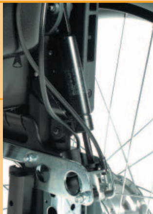
Rücken flexibel winkelverstellbar (Gasdruckfeder)
