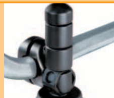
Einstellen des Sitzneigungswinkels durch Drehen der Stellhülse auf 0, 3 oder 6°
