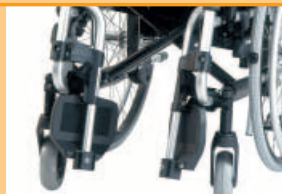
Fußrasten nach innen und außen schwenkbar
