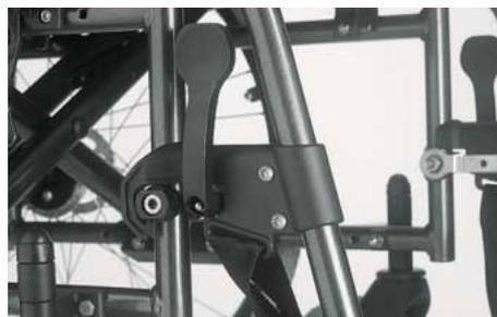
Der Entriegelungshebel für die einfache und schnelle Fußrastenentriegelung
