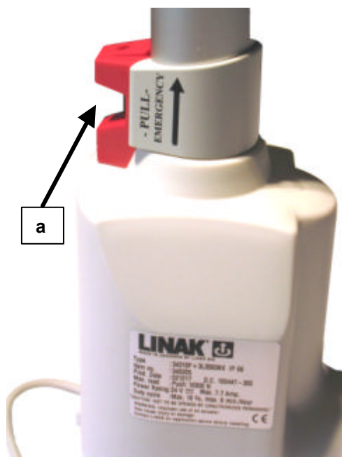
Abb. 5 Hubmotor LA 34 / Mechanische Notabsenkung
